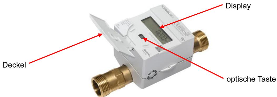
Beim Aufklappen des Deckels wird das Display automatisch aktiviert. Dabei wird zunächst eine Prüfung der Anzeige durchgeführt (alle Symbole leuchten kurz auf).
